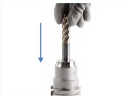
Abb. 7: Werkzeug einschieben
